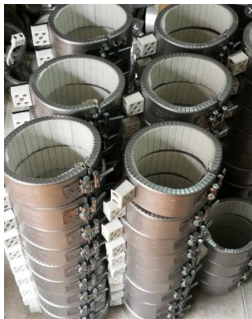
图 1：家里生产的传统陶瓷加热圈
